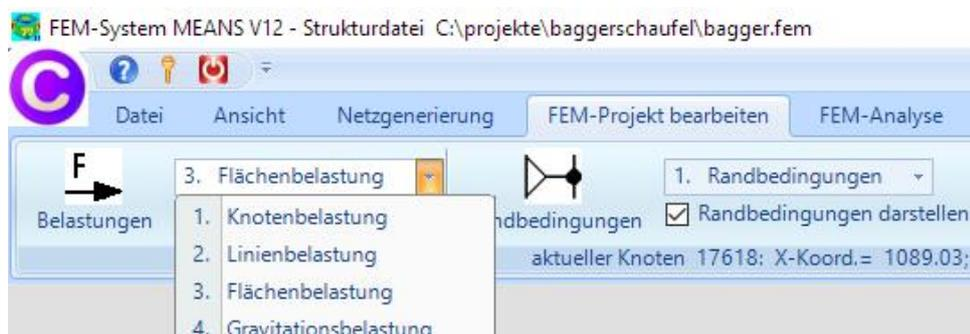
Klicken Sie auf „N/mm<sup>2</sup>“ und „ungleich entlang X-Achse W2“ und geben W1 = 0 und W2 = 10 ein und wählen die Optionen „senkrecht zur Fläche“ und „alle angezeigten Knoten“ und erzeugen mit „Belastung erzeugen“ die Flächenlast.
