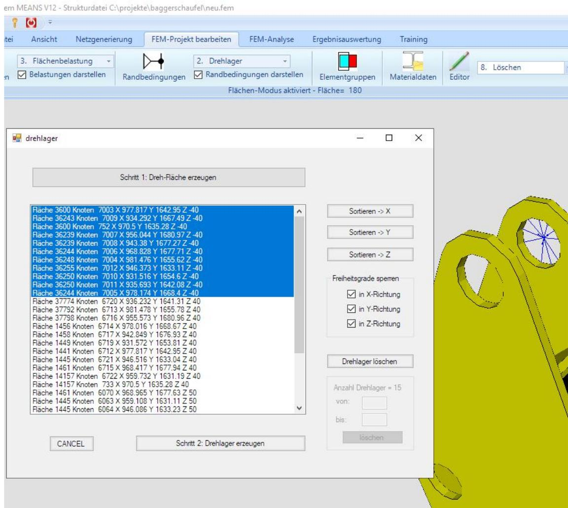
Markieren Sie nun auf die ersten 11 Flächenknoten mit der Z-Koordinate -50 mm und erzeugen mit Menü „Schritt 2 Drehlager erzeugen“ das erste Drehlager. Dannach wiederholen Sie die Markierung und Schritt 2 für Z= - 40, 40 und 50 und erzeugen insgesamt 4 Drehlager.
